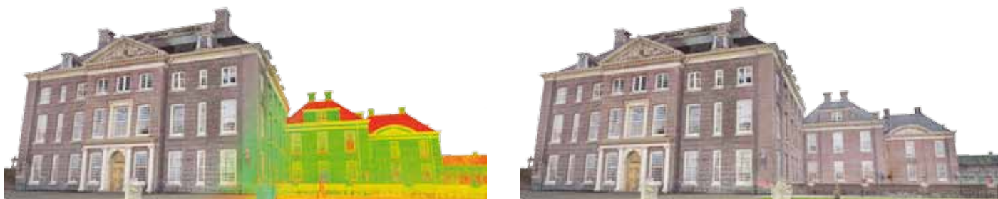
Uiteindelijk heeft Coenradie TruViews opgeleverd bij de opdrachtgever. Jos Westra zegt daarover: "In feite zijn dat de panoramafoto's met de gescande puntenwolk. Het resultaat is een foto waarin je kunt meten."
