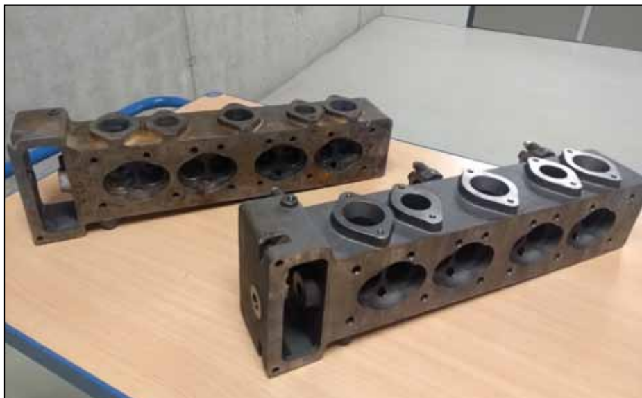
Links het origineel, rechts het bewerkte gietstuk van de cilinderkop.
